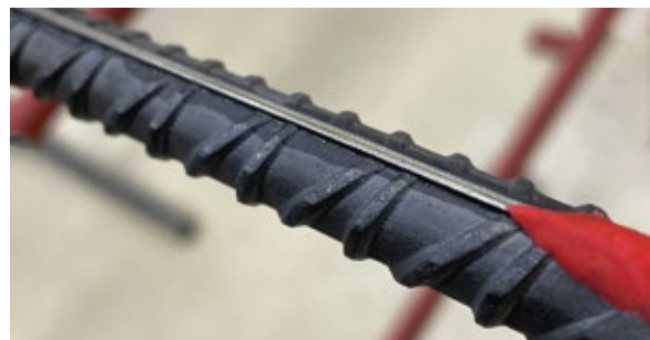
Applikation eines Sensors auf der Bewehrungsoberfläche
